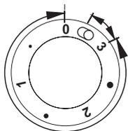
В диапазоне „0 • 1 • 2 • 3” ручки работает внутреннее поле нагрева и можно плавно регулировать количество подаваемого на посуду тепла. Временный перевод ручки в положение - («гусятница»), включает внешнее поле. С этого момента можно плавно регулировать количество тепла обоих нагревательных полей (внешнее и внутреннее) поскольку внутренний переключатель выключит оба поля только после установки положения ручки на 0.
