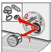
5. Осторожно отвинтите крышку насоса. Прочистите насос внутри, резьбу крышки насоса и корпус насоса (лопастное колесо насоса для стирального раствора должно свободно вращаться).
