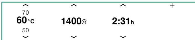
Стрелки на участке дисплея указывают на кнопки, с помощью которых можно изменить установки. Установки активируются без подтверждения и отображаются в главном меню.
