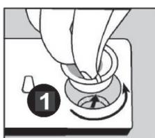
Если загорается лампочка ополаскивателя на панели управления, то следует заполнить отделение для ополаскивателя.
