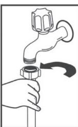
Не используйте шланг подачи воды от вашей старой машины, если такой имеется. Напротив, замените его на новый, прилагающийся к вашей машине. Если вы собираетесь подключить новый или давно не использовавшийся шланг подачи воды, то перед подсоединением к машине пропустите через него воду. Соедините шланг подачи воды
