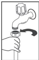
Не используйте шланг подачи воды от вашей старой машины, если такой имеется. Напротив, замените его на новый, прилагающийся к вашей машине. Если вы собираетесь подключить новый или давно не использовавшийся шланг подачи воды, то перед подсоединением к машине пропустите через него воду. Соедините шланг подачи воды
