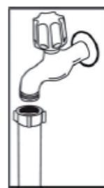
непосредственно к водопроводному крану. Давление подаваемой воды должно быть не меньше 0,03 Мпа, но не больше 1 Мпа. Если давление превышает 1 Мпа, то для снижения давления должен быть установлен специальный клапан между краном и шлангом. После подключения вода должна быть полностью включена, чтобы проверить соединения на герметичность.
