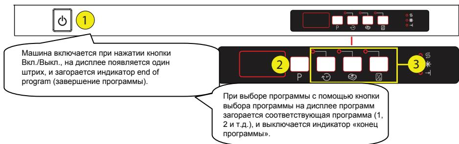
Машина включается при нажатии кнопки Вкл./Выкл., на дисплее появляется один штрих, и загорается индикатор end of program (завершение программы).
