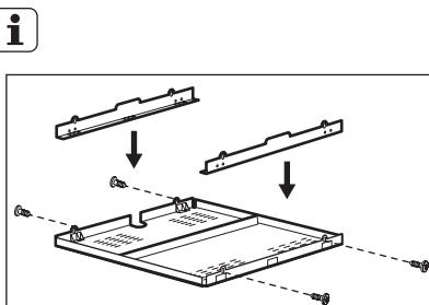
В случае использования защитного короба (дополнительная принадлежность<sup>1)</sup>), установка защитного пола непосредственно под устройством не является обязательной. В случае установки прибора над духовым шкафом использование защитного экрана невозможно.
