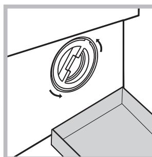
1. снимите переднюю панель стиральной машины, нажав в центре, затем потяните ее вниз за края и снимите ее (см. схемы).
