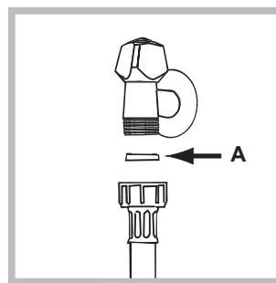
2. Вставьте прокладку A в конец водопроводного шланга и привинтите его к водопроводному крану холодной воды с резьбовым отверстием 3/4 дюйма (см. схему). Перед подсоединением откройте водопроводный кран до тех пор, пока из него не потечет чистая вода.
