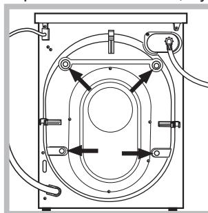
2. Снимите 4 винта, предохраняющие машину в процессе перевозки, и распорки, расположенные в задней части машины (см. схему).
