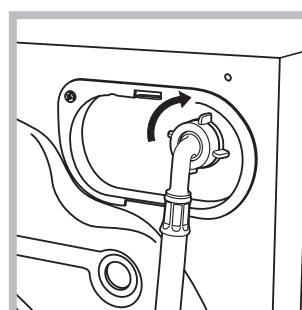
1. Подсоедините шланг к машине, привинтив его к специальному крану, расположенному в задней верхней части справа (см. схему).
