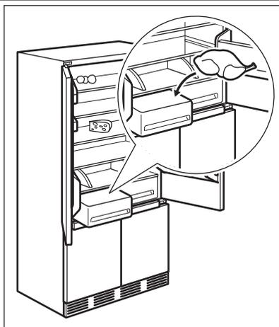
Температура в этом отделении (от 0°C до +3°C) поддерживается постоянной с помощью специального датчика. Регулировка не требуется.
