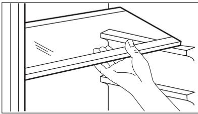
Расположенные на стенках холодильника направляющие позволяют размещать полки на нужной высоте.
