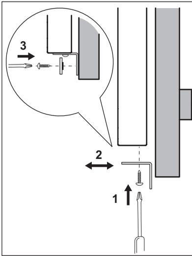
При помощи двух пластиковых шайб, имеющих в коробке с принадлежностями, прикрепите к панели кронштейн, расположенный под дверцей. Затем установите крышку держателя на место.
