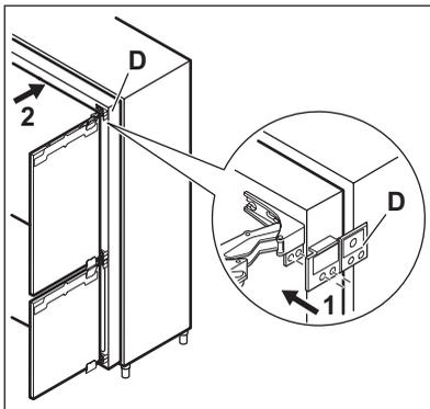
Прежде чем устанавливать прибор в шкаф, установите прокладки на петли. См. рисунок.
