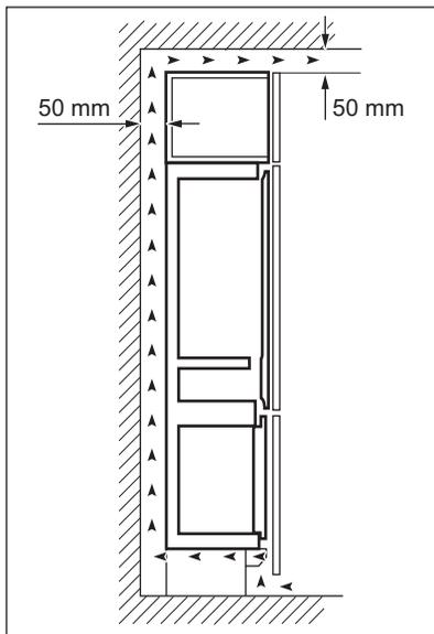
Чтобы обеспечить лучшую циркуляцию воздуха, верхняя поверхность прибора должна быть свободна. Если над прибором находится навесная мебель, то между ней и стеной должен быть зазор в 50 мм, и она должна находиться на расстоянии не менее 50 мм от потолка.
