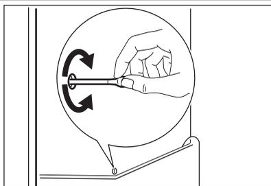
При нормальных условиях эксплуатации удаление инея с испарителя холодильной камеры происходит автоматически при каждом включении компрессора. Талая вода стекает через сливное отверстие в специальный поддон, установленный с задней стороны прибора над компрессором, а затем испаряется. Необходимо регулярно прочищать сливное отверстие, находящееся в середине канала холодильного отделения, во избежание накопления воды и попадания капель на находящиеся внутри продукты.
