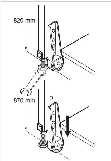
Прежде чем устанавливать прибор между элементами кухонной мебели, отрегулируйте высоту ножек и задних колес. На заводе колеса установлены для высоты 820 мм. Чтобы выровнять прибор по высоте 870 мм, поднимите его, регулируя высоту ножек с помощью гаечного ключа, затем снимите колеса и снова установите их в самое нижнее положение.
