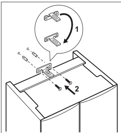
Установите прибор в нишу. Поверните кронштейн на 180°, чтобы он занял правильное положение (2). При поставке он находится в положении (1). С помощью соответствующего кронштейна прикрепите его к стене.
