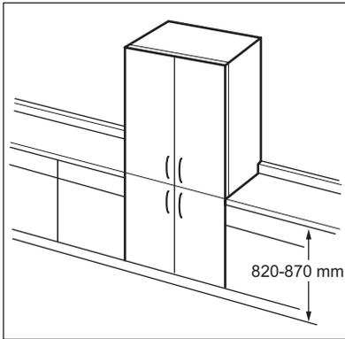
Чтобы обеспечить выравнивание по высоте с существующей кухонной мебелью, высоту прибора можно регулировать от 820 мм до 870 мм.
