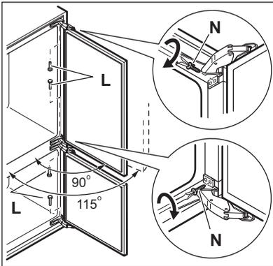
При необходимости угол открытия двери можно ограничить 90° с помощью шарниров, поставляемых отдельно. См. рисунок.
