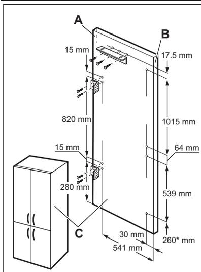
Прикрепите к панелям кронштейны в положениях, показанных на рисунке. Для установки цоколя высотой 100 мм внизу панели предусмотрен отступ 260\* мм. Для цоколя других размеров следует соответствующим образом увеличить отступ.
