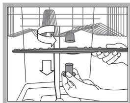
Для съема верхнего оросителя необходимо отвинтить против часовой стрелки пластмассовую гайку. Верхний ороситель устанавливается отверстиями вверх.
