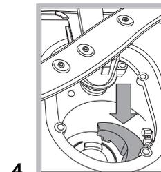
После чистки фильтров точно установите фильтрующий узел на свое место, что является важным для исправной работы посудомоечной машины.
