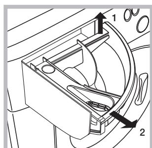
Выньте распределитель, приподняв его и потянув наружу (см. схему). Промойте распределитель теплой водой. Эта операция должна выполняться регулярно.
