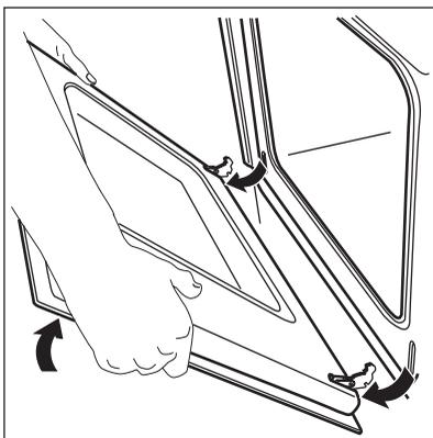
3. Прикройте дверцу до первого фиксируемого положения (наполовину). Затем вытяните дверцу вперед из ее гнезда.
