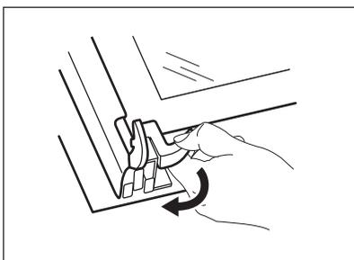
5. Отожмите стопоры, чтобы снять стеклянные панели.
