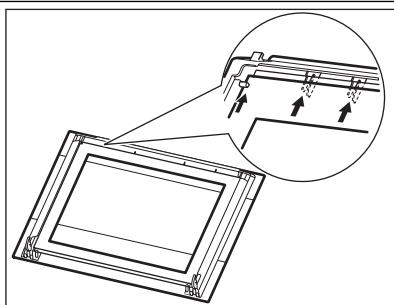
После окончания очистки установите стеклянные панели и дверцу духового шкафа. Выполните перечисленные выше действия в обратной последовательности.
