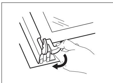
5. Отожмите стопоры, чтобы снять стеклянные панели.
