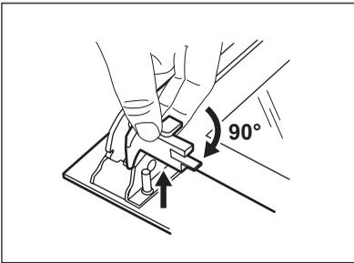
6. Поверните два фиксатора на 90° и извлеките их из своих гнезд.
