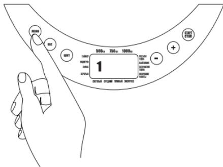
Проверьте комплектацию устройства, удостоверьтесь в том, что все детали установлены на свои места. Очистите все детали в соответствии с инструкциями, приведенными в разделе «Очистка и уход». Установите режим «основная программа» и дайте пустой печи поработать в этом режиме в течение 10-15 минут. Затем дайте печи охладиться, отсоедините съемные детали и снова очистите их в соответствии с разделом «Очистка и уход». Полностью просушите детали и соберите их. Теперь печь готова к использованию.
