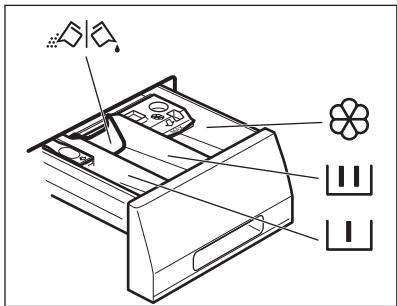
**I** Отделение для моющего средства, используемого на этапе предварительной стирки, замачивания или выведения пятен.
