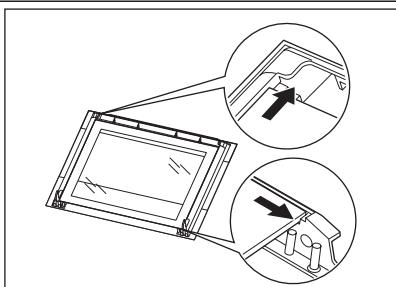
После окончания очистки установите стеклянную панель и дверцу духового шкафа. Выполните перечисленные выше действия в обратной последовательности.
