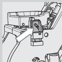
**9** Убедитесь, что фиксатор блока приготовления кофе находится в правильном положении, нажав кнопку «PUSH» до щелчка. Убедитесь в том, что фиксатор поднялся вверх до упора. В противном случае попробуйте еще раз.
