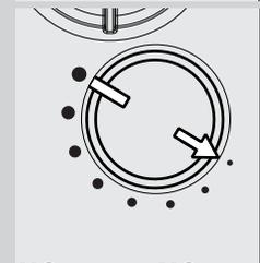
**2** Нажмите и поверните ручку регулировки помола только на одно деление за раз. Разница вкуса будет ощутимой после подачи 2-3 эспрессо.
