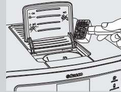
6 Насыпьте мерку предварительно намолотого кофе в отделение. Используйте только мерку, входящую в комплект поставки машины; затем снова закройте крышку отделения предварительно намолотого кофе.
