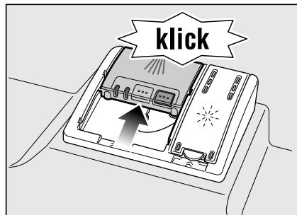
Камера с мыющим средством открывается автоматически в зависимости от выбранной программы в самый подходящий для этого момент времени. Порошкообразное или жидкое мыющее средство распределяется внутри машины и затем растворяется, таблетка падает в предназначенную для нее подставку и, находясь в ней, постепенно растворяется.
