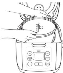
Тщательно вымойте рабочую емкость и паровой клапан, вытрите их насухо, затем установите на место.
