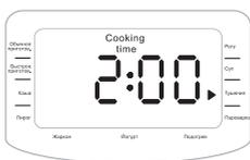
2. Вы можете установить нужное Вам время приготовления. Для этого, нажмите на кнопку **«ВРЕМЯ ПРИГОТОВЛЕНИЯ»** и с помощью кнопок **«ЧАСЫ»** и **«МИНУТЫ»** установите нужное Вам время приготовления в интервале от 1 часа до 12-ти часов.
