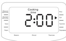
2. Вы можете установить нужное Вам время приготовления. Для этого, нажмите на кнопку **«ВРЕМЯ ПРИГОТОВЛЕНИЯ»** и с помощью кнопок **«ЧАСЫ»** и **«МИНУТЫ»** установите нужное Вам время приготовления в интервале от 1 часа до 4-х часов.
