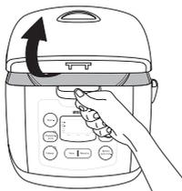
Извлеките из прибора рабочую емкость, а также паровой клапан (расположен на верхней части крышки)
