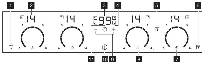
Управление прибором осуществляется с помощью сенсорных полей. Работа функций подтверждается выводом информации на дисплей, а также визуальной и звуковой индикаций.
