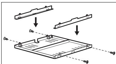
В случае использования защитного короба (дополнительная принадлежность <sup>1)</sup>), фронтальный 5-мм вентиляционный зазор и защита пола под прибором не являются обязательными.
