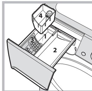
Эта функция служит для удаления наиболее трудных пятен. Вставьте дополнительный прилагающийся дозатор 4 в дозатор 1. При заливке отбеливателя не превышайте "макс." уровень, указанный на стержне в центре (см. схему). Для выполнения только отбеливания залейте отбеливатель в дополнительный дозатор 4, выберите
