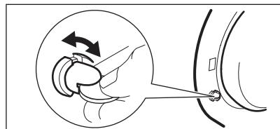
Если данное устройство включено, то закрыть дверцу невозможно. Это позволяет избежать опасности запирания дверцы в случае попадания в барабан детей или домашних животных. Чтобы включить данное устройство, поверните переключатель по часовой стрелке так, чтобы канавка оказалась в горизонтальном положении. Чтобы выключить данное устройство, поверните переключатель против часовой стрелки так, чтобы канавка оказалась в вертикальном положении.
