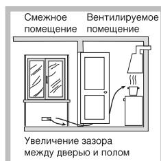
Или же воздух для горения может поступать из смежных помещениях, оснащенных вентиляционным отверстием, выходящим в атмосферу, как описано выше, при условии, что эти помещения не являются зонами общего пользования,
