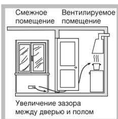
Или же воздух для горения может поступать из смежных помещений, оснащенных вентиляционным отверстием, выходящим в атмосферу, как описано выше, при условии, что эти помещения не являются зонами общего пользования,
