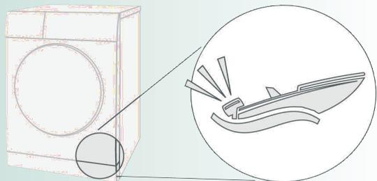
*Компрессор сушильной машины может периодически издавать звук гудения. Громкость и интервал этого звука может быть различным в зависимости от выбранной программы и этапа сушки.*
