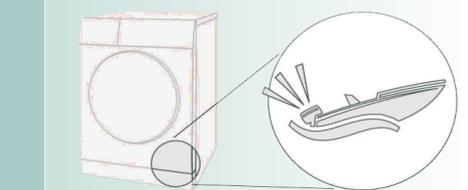
Компрессор сушильной машины может периодически издавать звук гудения. Громкость и интервал этого звука может быть различным в зависимости от выбранной программы и этапа сушки.
