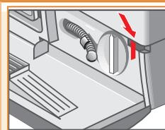
Программа продолжается после возобновления подачи тока. В случае необходимости выгрузки белья из машины дверцу можно открыть следующим образом:
