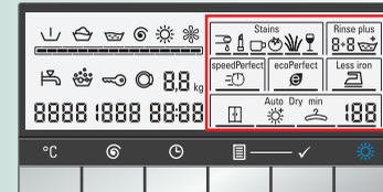
Символ дополнительной функции показан на дисплее, если эту функцию можно набрать в выбранной программе. Символ выключен, если дополнительную функцию уже нельзя выбрать в ходе выполнения программы.
