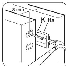
Снимите кронштейны и отметьте расстояние 8 мм от внешнего края дверцы: это место для гвоздя (K).
