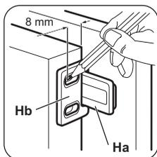
Откройте дверцу прибора и дверцу кухонной мебели под углом 90°. Вставьте маленькую планку (Hb) в направляющую (Ha). Совместите друг с другом дверцу прибора и дверцу кухонной мебели, затем наметьте отверстия.
