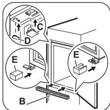
Установите крышки (C, D) в выемки и отверстия под петлю. Установите вентиляционную решетку (B). Наденьте крышки петли (E) на петлю.
