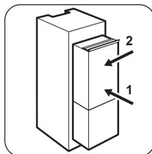
Установите прибор в нишу. Сдвиньте прибор в направлении, указанном стрелками (1), чтобы крышка, закрывающая верхний зазор, уперлась в кухонный шкаф. Сдвиньте прибор в направлении, указанном стрелками (2), к боковой стенке кухонного шкафа, на которой нет петель.
