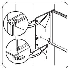
Закрепите прибор внутри ниши 4-мя винтами.
