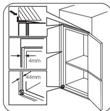
Отрегулируйте положение прибора внутри ниши. Убедитесь, что расстояние между прибором и передним краем кухонного шкафа составляет 44 мм. Крышка нижней петли (находится в пакете с принадлежностями) обеспечивает надлежащее расстояние между кухонной мебелью и прибором. Убедитесь, что ширина зазора между прибором и кухонным шкафом равняется 4 мм. Откройте дверцу. Установите крышку нижней петли.
