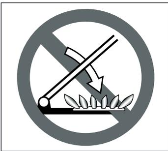
**Внимание!** От жара стеклянная крышка прибора может треснуть. Прежде чем накрыть прибор стеклянной крышкой, выключите все конфорки. Подождите до полного остывания плиты.
