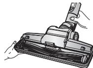
3. С помощью ножниц удалите с щеточного вала пыль и шерсть.
