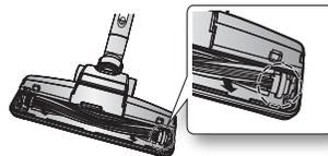
6. Установите на место прозрачную экранирующую крышку, нажав ее до щелчка.
