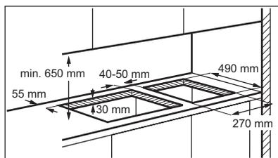
В случае, если несколько 30 см варочных поверхностей необходимо установить одну рядом с другой в одном вырезе столешницы, можно обратиться в сервисный центр за набором для монтажа, который включает в себя боковую опорную скобу и дополнительные уплотнители. Необходимые инструкции находятся внутри упаковки данного набора.
