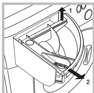
Выньте распределитель, приподняв ее и потянув наружу (см. схему). Промойте распределитель теплой водой. Эта операция должна выполняться регулярно.
