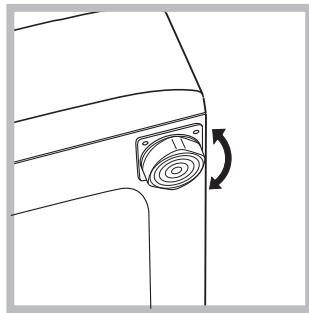
2. Если пол не является идеально горизонтальным, необходимо компенсировать неровность, отрегулировав по высоте передние ножки (см. схему). Уклон, измеренный при помощи уровня, установленного на поверхность машины, не должен превышать 2°.
