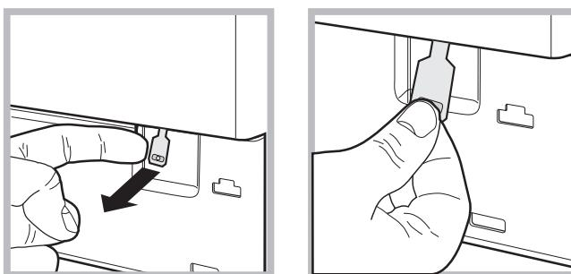
4. потяните наружу язычок, показанный на схеме, вплоть до освобождения пластикового блокировочного винта. Затем потяните его вниз и одновременно откройте люк.
