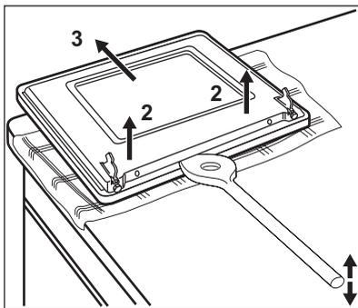
5. Используйте лопатку, сделанную из дерева, пластмассы или аналогичного материала, чтобы открыть внутреннюю дверцу. Удерживая внешнюю дверцу, толкните внутреннюю дверцу по направлению к верхнему краю дверцы.
