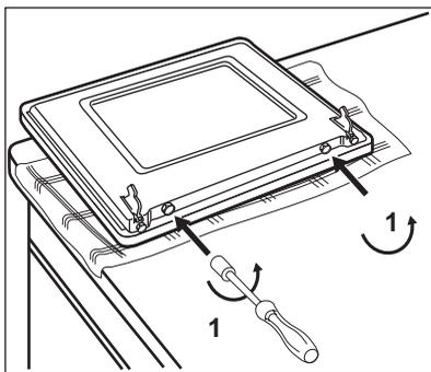
4. Положите дверцу на устойчивую поверхность, подложив под дверцу мягкую ткань. Используйте отвертку, чтобы извлечь два винта с нижнего края дверцы.
