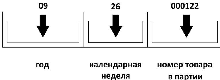
В данном примере прибор изготовлен на 26 неделе 2009 года.
