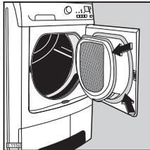
Не надо прочищать область фильтров после каждого цикла сушки. Достаточно лишь регулярно осматривать и очищать ее от волокон по мере необходимости. Откройте загрузочную дверцу. Фильтр для задержания волокон в нижней части заливного отверстия очистить смоченной в воде рукой.
