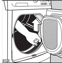
Снова вставьте фильтр. Ни в коем случае нельзя эксплуатировать сушильную машину без фильтров, с поврежденными или засоренными фильтрами для волокон.
