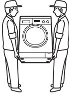
Сначала наклоните прибор назад. Для транспортировки прибора требуется два человека, по одному с каждой стороны. Прибор следует держать за дно.
