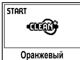
После серии подач молока повернуть главную ручку направо, как для включения подачи горячей воды: появится изображение "CLEAN+", установить емкость под устройство подачи и нажать левую верхнюю кнопку для начала операции чистки; после чего вернуть ручку в центральное положение, чтобы было возможно выполнять другие программы подачи.
