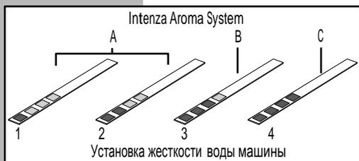
Номера соответствуют установкам, которые найдете в регулировке жесткости воды, показанной в главе программирования.
