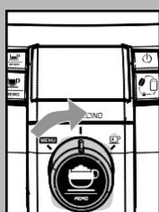
Для выхода из режима программирования установить переключатель в положение "I".
