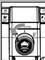
Для входа в меню программирования повернуть переключатель против часовой стрелки до “MENU”.
