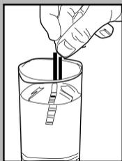
Измерение жесткости воды очень важно для корректного управления фильтром Intenza и интенсивностью удаления накипи в машине.
