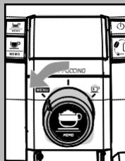
При включенной машине войти в меню программирования, повернув переключатель против часовой стрелки до "MENU".
