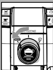
Повернуть переключатель против часовой стрелки до достижения "MENU". Первое использование машины.
