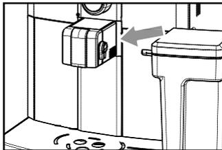
3 Снова установить трубку подачи внутрь емкости и закрыть крышку, нажимая ее до упора.
