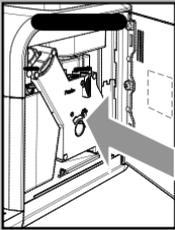
**i** Смазать блок приготовления кофе после примерно 500 порций кофе. Консистентную смазку для смазывания блока приготовления кофе можно приобрести в авторизованных центрах технического обслуживания.
