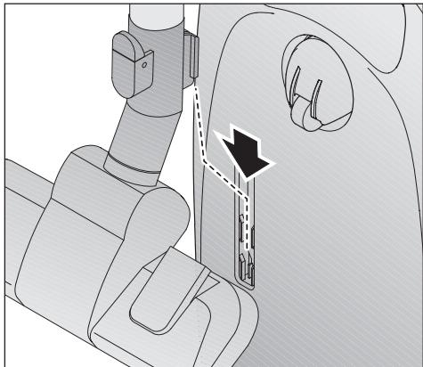
Если ваш пылесос оснащен трубкой EasyLock, для него имеется возможность компактного хранения.
