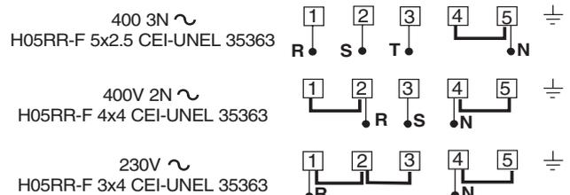
Порядок подсоединения кабеля электропитания:
