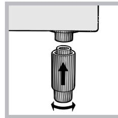
При необходимости выровнять изделие вкрутите в специальные отверстия по углам в основании кухонной плиты прилагающиеся регулирующие ножки\* по (см. рисунок).
