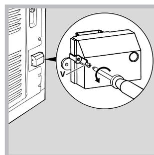
1. Отвинтите шуруп V на зажимной коробке и снимите крышку (см. рисунок).
