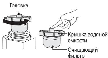
3. Промойте водяную емкость проточной водой и полностью высушите ее в затененном месте.
