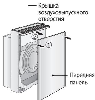
2. Промойте крышку проточной водой и полностью высушите ее в затененном месте.
