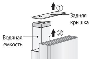
2. Поверните крышку водяной емкости.
