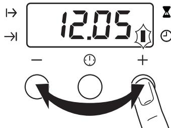
При включении прибора в сеть или при сбое электропитания автоматически начинает мигать индикатор режима текущего времени.
