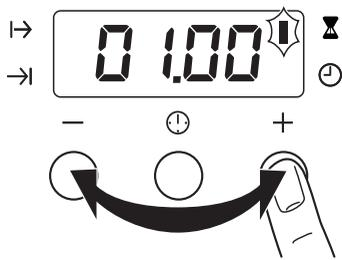
3. Для установки таймера ⌚, времени приготовления |→| или времени окончания приготовления →|, нажмите кнопку "+" или "-".
