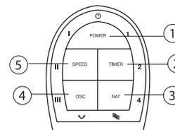
1. POWER Кнопка включения прибора
