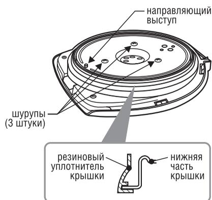
Для разборки крышки снимите ее с термопота, переверните нижней частью
