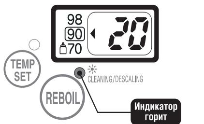
После того, как вода вскипела, загорится индикатор сохранения тепла и термopот перейдет в режим поддержания температуры на уровне 90°C.
