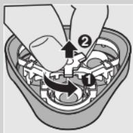
**2** Нажмите кнопку отсоединения бритвенного блока (1) и снимите бритвенный блок (2).
