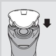
**1** Для предотвращения повреждений надевайте на электробритву защитный колпачок.
