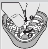
**4** Снимите старые бритвенные головки и вставьте в бритвенный блок новые бритвенные головки.
