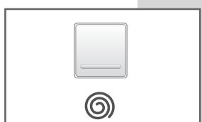
**ПРЕДВАРИТЕЛЬНАЯ СТИРКА** Чтобы выполнить предварительную стирку вещей, нажмите кнопку D и добавьте моющее средство в специальное отделение 1. Стиральная машина выполняет предварительную стирку при температуре макс. 40°C. Предварительную стирку рекомендуется проводить для вещей, испачканных пылью, землей и песком, или при наличии застаревших пятен. Дальнейшую информацию см. в Таблице программ.
