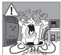
**Не используйте удлинители или тройники для подключения стиральной машины к электрической розетке.**
