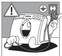
**Стиральная машина должна быть подключена к соответствующей правилам безопасности электрической розетке с заземлением.**
