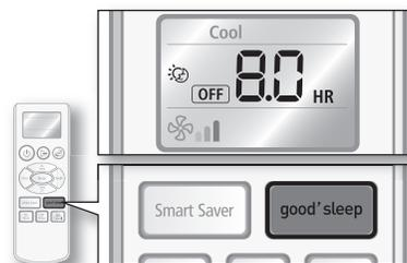
3. Задайте время, в течение которого кондиционер должен работать в данном режиме.
