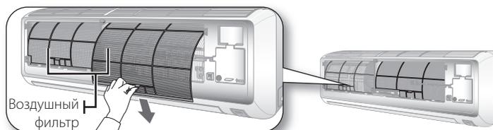
3. Вычистите воздушный фильтр пылесосом или мягкой щеткой. Если загрязнение фильтра значительное, промойте его проточной водой и просушите на воздухе.
