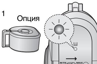
Пылесборник следует опорожнять после достижения отметки заполнения или включения индикатора заполнения.
