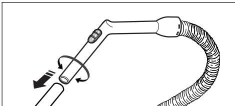
2) Соедините вместе колена всасывающей трубы (в зависимости от модели).
