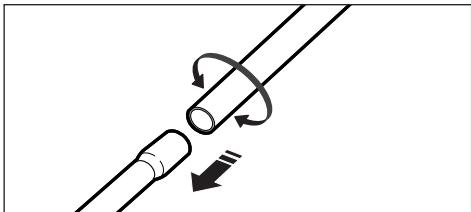
3) Оденьте насадку на трубку всасывания.
