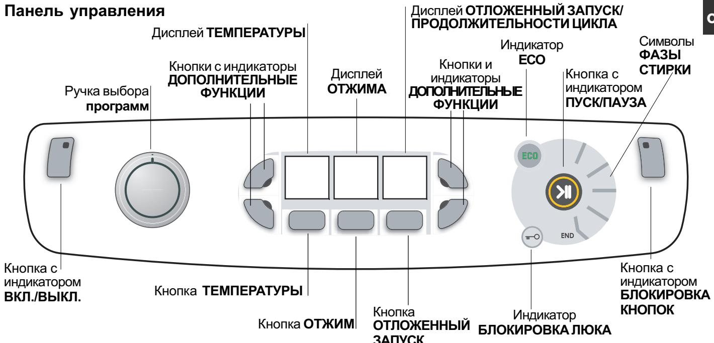
Кнопка с индикатором **ВКЛ./ВЫКЛ.**: нажмите кнопку один раз для включения или выключения машины. Зеленый индикатор показывает, что машина включена. Для выключения стиральной машины в процессе стирки необходимо держать нажатой кнопку, примерно 3 секунды. Короткое или случайное нажатие не приведет к отключению машины. В случае выключения машины в процессе стирки текущий цикл отменяется.
