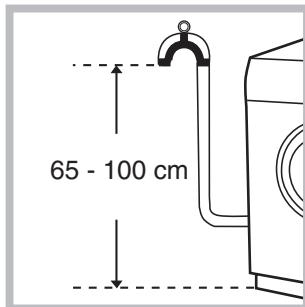
Подсоедините сливной шланг, не сгибая его, к сливному трубопроводу или к сливному патрубку в стене, расположенному на высоте 65 – 100 см от пола.
