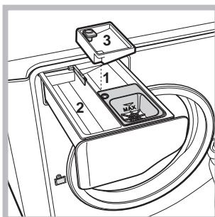
Эта функция служит для удаления наиболее трудных пятен. Вставьте дополнительный прилагающийся дозатор 3 в дозатор 1. При заливе отбеливателя не превышайте "макс." уровень, указанный на стержне в центре (см. схему). Для выполнения только отбеливания
