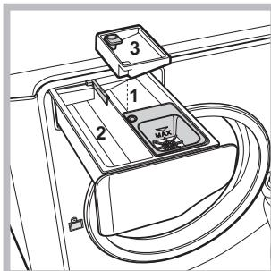
Эта функция служит для удаления наиболее трудных пятен. Может использоваться как с отбеливателем, так и без него. Если требуется произвести также отбеливание, вставьте дополнительный прилагающийся дозатор 3 в ячейку 1.
