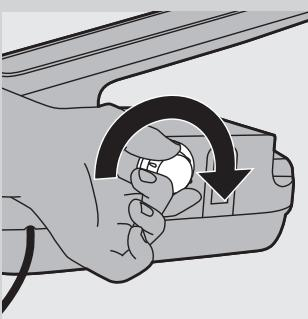
**9** Крепко затяните крышку системы очистки от накипи Calc-Clean на парогенераторе.
