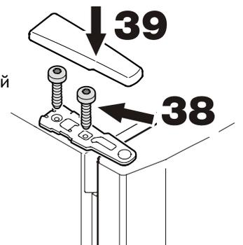
При необходимости выровняйте двери в двух продольных отверстиях внизу и по центру опорного кронштейна вровень с корпусом прибора.
