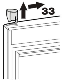
34. Заправьте кабель опорного кронштейна на противоположной стороне и вставьте опорный кронштейн.
