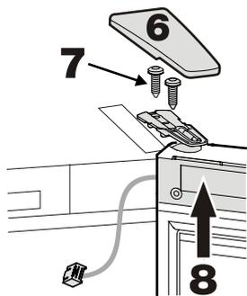
9. Переставьте защитную крышку на противоположную сторону.
