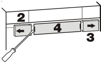
3. Снимите крышку со стороны шарниров: с помощью шлицевой отвертки выведите ее влево из зацепления и сдвиньте наружу.
