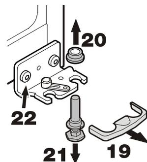
23. Переставьте опору шарнирного уголка на противоположную сторону.
