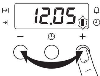
При включении прибора в сеть или при сбое электропитания автоматически начинает мигать индикатор режима текущего времени.
