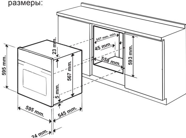
! После встраивания изделия в кухонный элемент должна быть исключена возможность касания к электрическим частям. Расход электроэнергии, указанный на паспортной табличке изделия, был замерян для данного типа монтажа.
