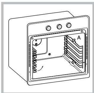
1. Отсоедините две рамы, сняв их с распорных элементов А (см. схему).
