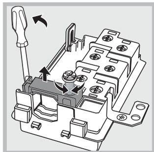
2. Отвинтите винт кабельного сальника и выньте его, поддев отверткой (см. схему).
