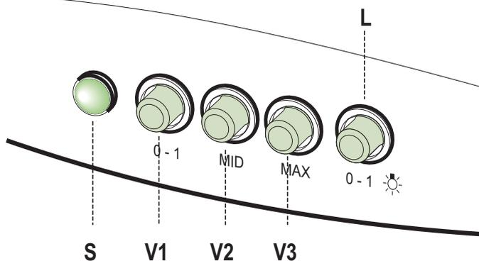
**L** Освещение Включает и выключает осветительное оборудование.
