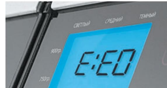
Если после нажатия на кнопку СТАРТ/СТОП на дисплее появились надписи «E E0» или «E E1», это означает, что неправильно работает датчик температуры. Для проверки датчика обратитесь в сервисный центр.
